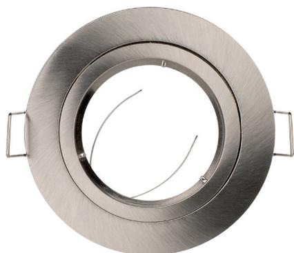
Spot encastré avec cadre en aluminium. Convient pour les lampes halogènes GU10 / GZ10 à tension secteur. Maximum 50W. Contient un kit de montage GU10 (patère et douille GU10 pré-connectée). Fixation de la lampe par bague 1/4 tour.
